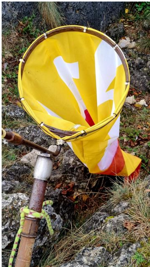
Befestigung am Stahlring (Durchmesser 33cm) mit Kabelbinder + Bindendraht
