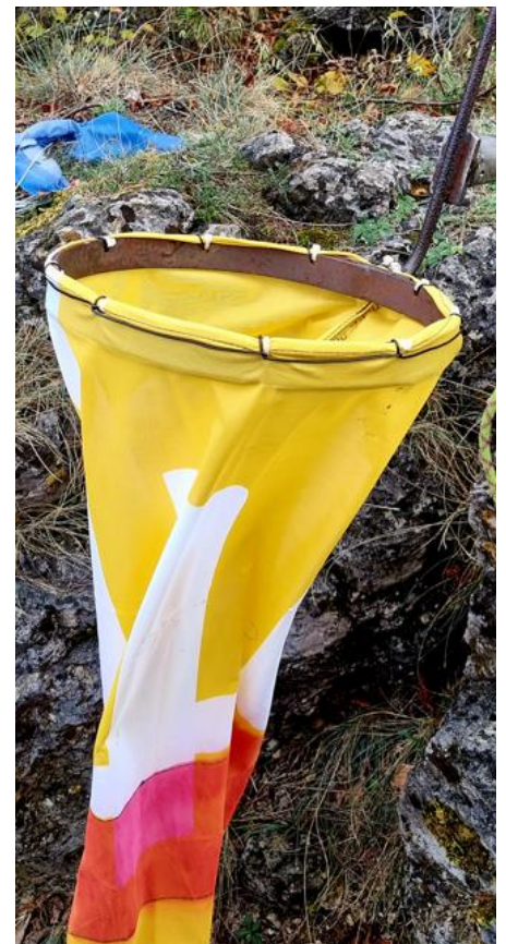
Befestigung am Stahlring (Durchmesser 33cm) mit Kabelbinder + Bindendraht
