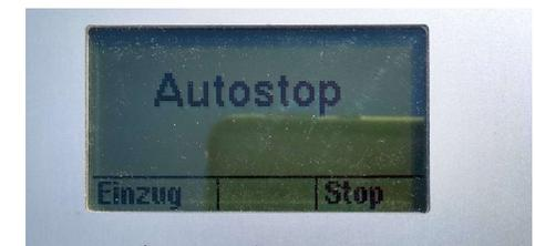
ermöglicht manuelles Einziehen bis zur Winde
